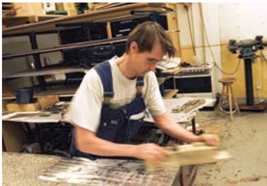
Stora bilden: Andreas Brauner testar den nylödade pipan. Små bilder: Sven Rosvall hyvlar en metallplåt som ska rundas till en pipa. Tre stora tornhuvar med profiler till Rochesterorgeln. Spelbordet till Rochesterorgeln.
