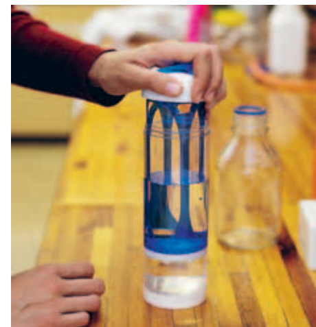
Enkel teknik. Forskarassistenten Michéle de Kwaadsteniet och professor Eugene Cloete visar maskinen som väver nanofiber på filter. Forskarlaget har utvecklat ett filter som passar halsen på en flaska, som filtrerar kemikalier och dödar bakterier. Filtret är en kombination av nanofiber, biocider och aktiverat kol.
