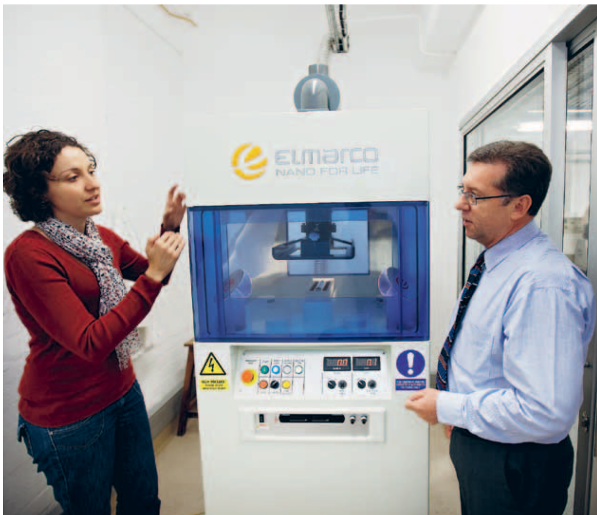
Enkel teknik. Forskarassistenten Michéle de Kwaadsteniet och professor Eugene Cloete visar maskinen som väver nanofiber på filter. Forskarlaget har utvecklat ett filter som passar halsen på en flaska, som filtrerar kemikalier och dödar bakterier. Filtret är en kombination av nanofiber, biocider och aktiverat kol.
